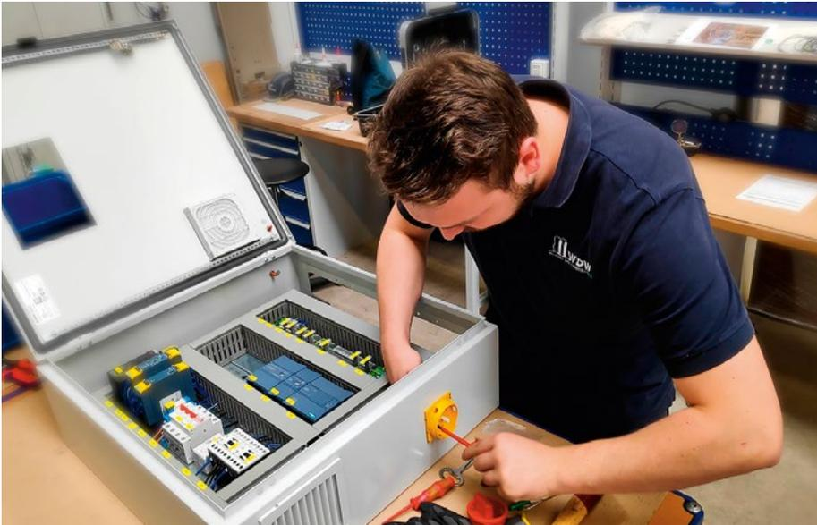
Steuerungsbau für die Automatisierung der WDW-Anlagentechnik.
