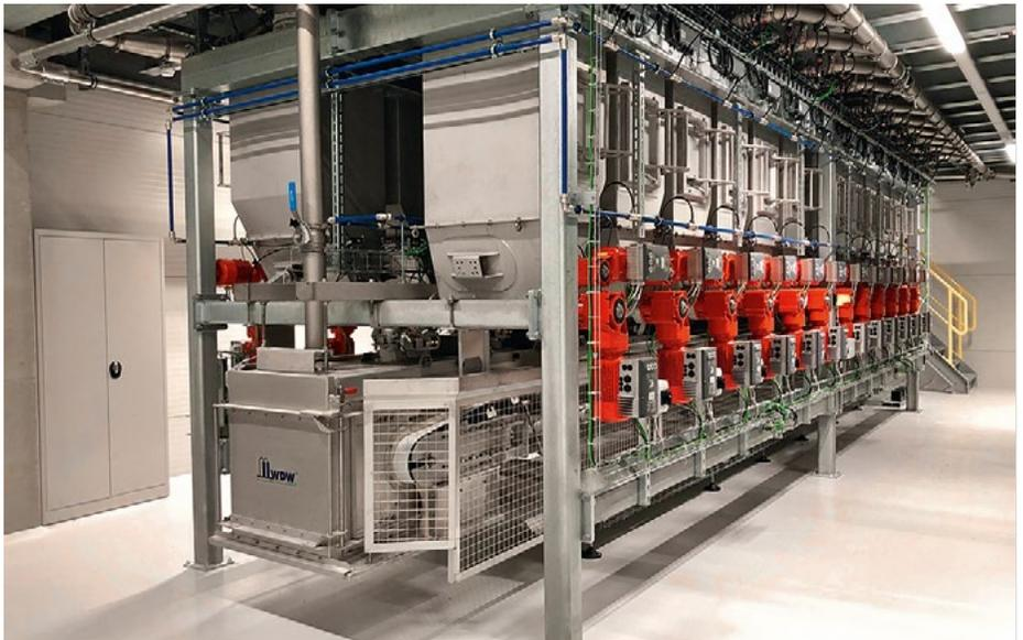
Differentialwaagensystem für Mikrokomponenten.
