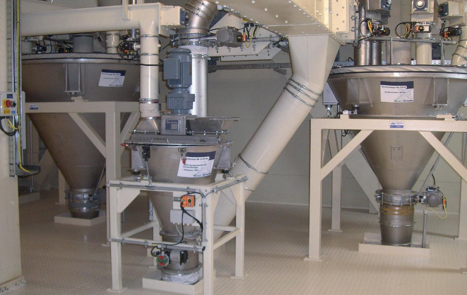
Konusdosierwaagen im Einsatz | Conical metering scale in use
