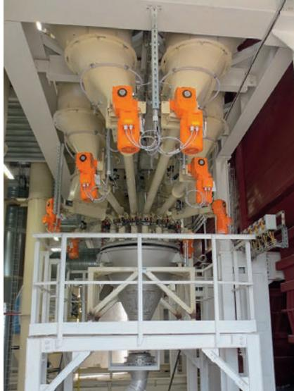
Mikrodosieranlage für 12 Komponenten
