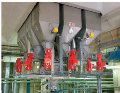
Mikrodosieranlage für 12 Komponenten
